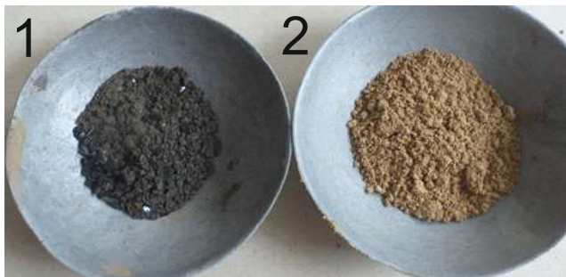
Рисунок –1. Загальний вигляд компонентів суміші: 1 – зола виносу Миколаївської ТЕС; 2 – суглинок
